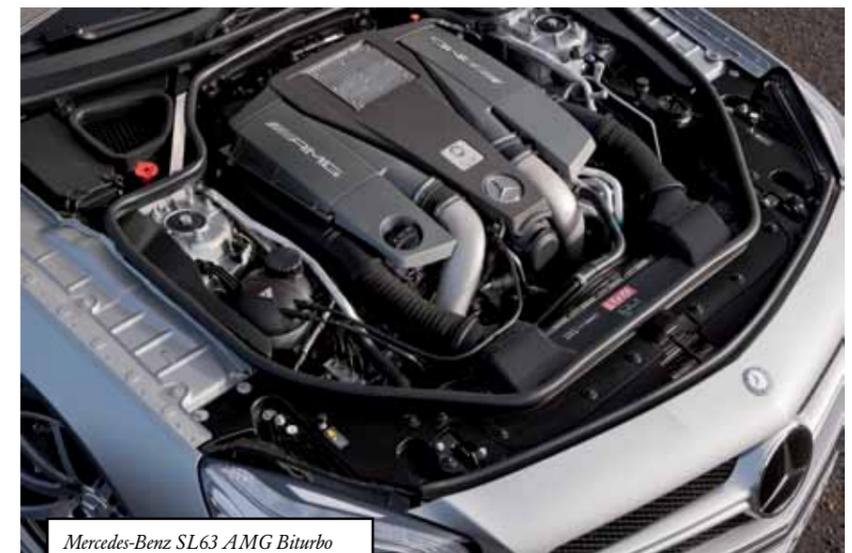
Mercedes-Benz SL63 AMG Biturbo mit wassergekühlter Ladeluftkühlung.
