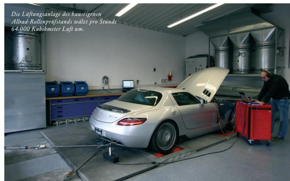
*Die Lüftungsanlage des hauseigenen Allrad-Rollenprüfstands wälzt pro Stunde 64.000 Kubikmeter Luft um.*
